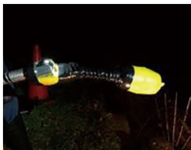
フロートスキッド 圧送管内に汚水が溜まっている場合、カメラヘッドを浮かばせて管内を視認できます。
