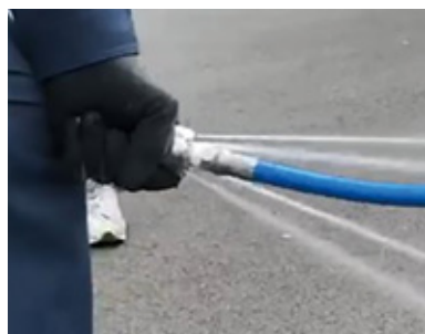
押し込み推進ノズル 曲がりなどで押し込みでは挿入できないとき、洗浄ノズルの推進力を使用できます。
